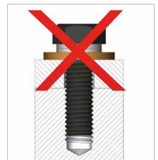
Geen borgingsfunctie in combinatie met onderleggringen
